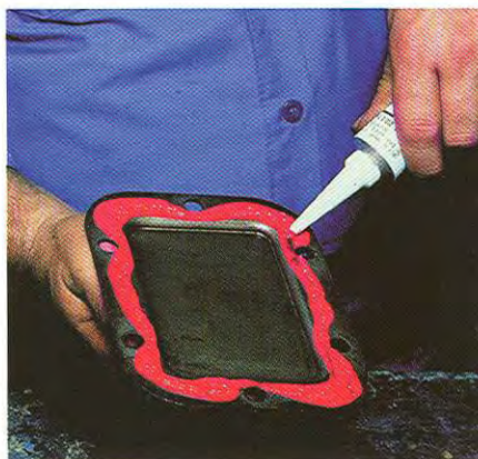
Silite® High Temp Silicone puede utilizarse para fabricar juntas moldeadas en el lugar para sellar y proteger contra la intemperie.
