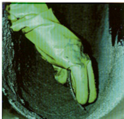
Además de proporcionar excelente resistencia a la abrasión, Combo Wear FC fragua rápidamente y permite regresar el equipo al servicio en tan sólo 1 ra hora.
