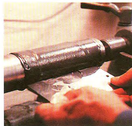
Ideal para reparaciones duraderas de ejes y equipos, Titanium Putty proporciona excelente resistencia a los productos químicos, ácidos, bases, solventes y temperaturas de hasta 176°C.
