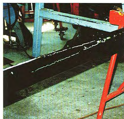
El Flexane® Brushable puede utilizarse para efectuar reparaciones rápidas y económicas de rodillos de caucho dañados o desgastados.
